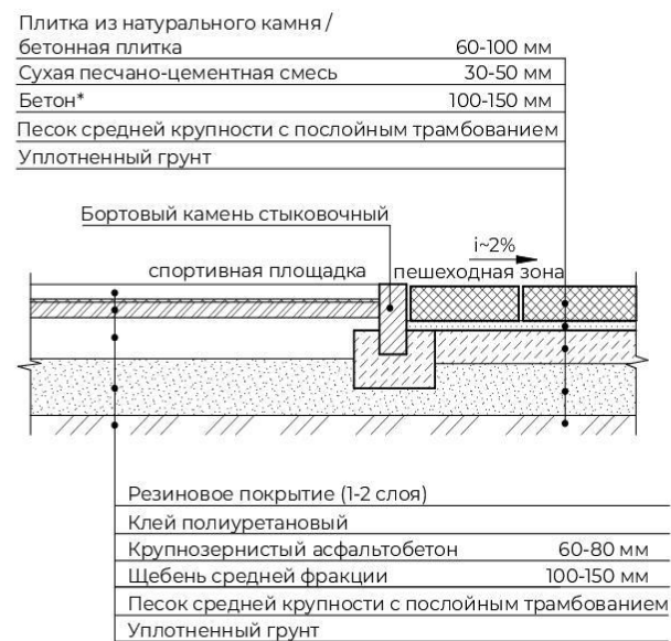
У.5. Принципиальная схема сопряжения спортивного покрытия и пешеходной зоны из бетонной плитки (плитки из натурального камня).
